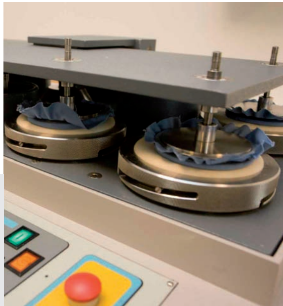
Essai d'abrasion d'une étoffe
